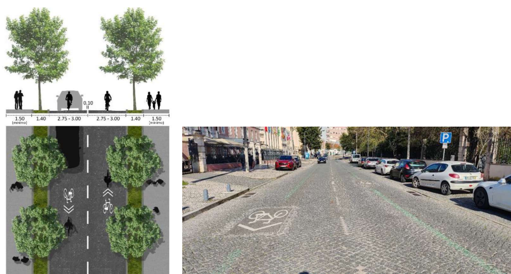
Figura 31. Perfil- tipo de canal partilhado com o automóvel e hipótese de trabalho
