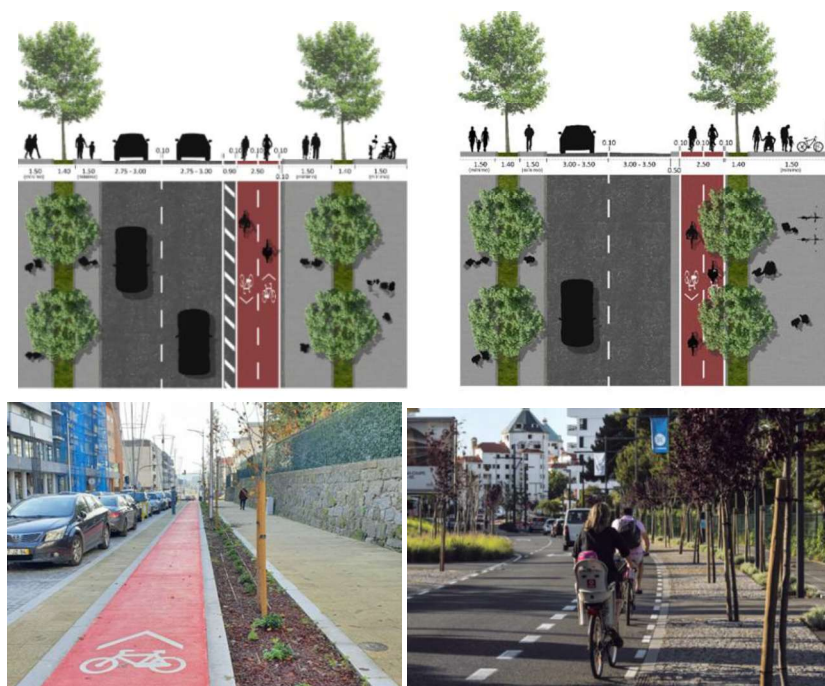
Figura 30. Perfis-tipo de canais próprios cicláveis – pista e corredor – e hipóteses de trabalho
