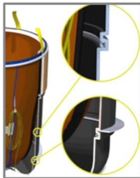
Esquema de encaixe dos aros interior e exterior
