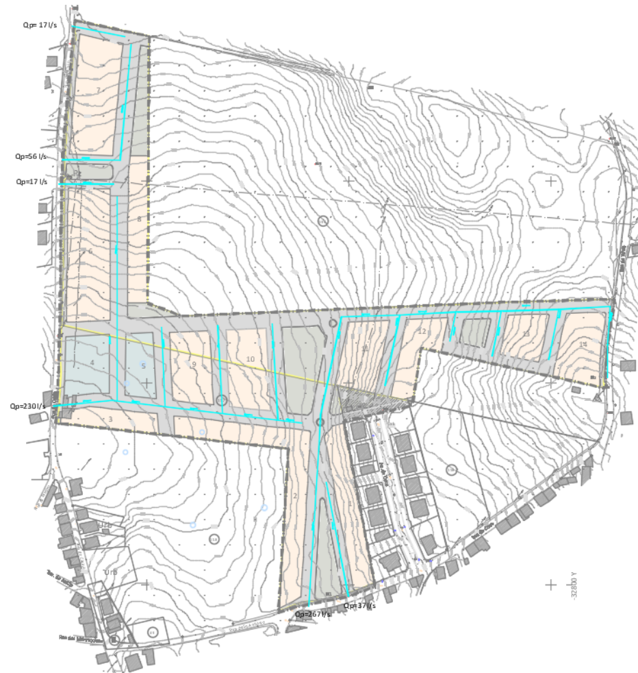
Figura 17: Proposta de saneamento de águas pluviais
