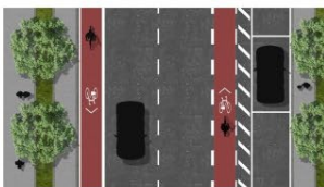
● 2.4. Corredor ciclável unidirecional com estacionamento longitudinal
