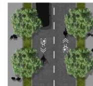
● 3.1. Ciclovia em canal partilhado na via
